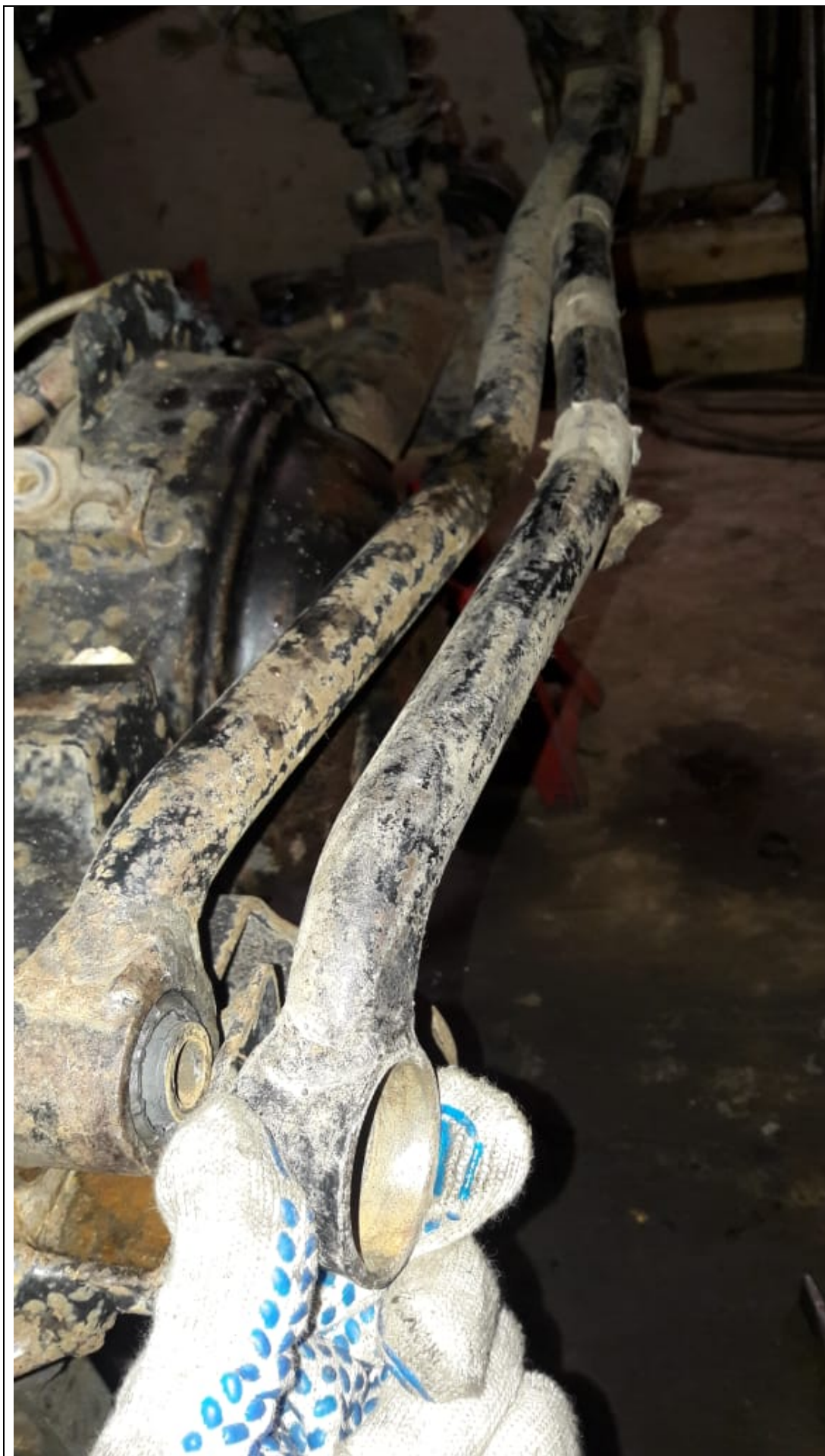
Изготовленная усиленная точка крепления
