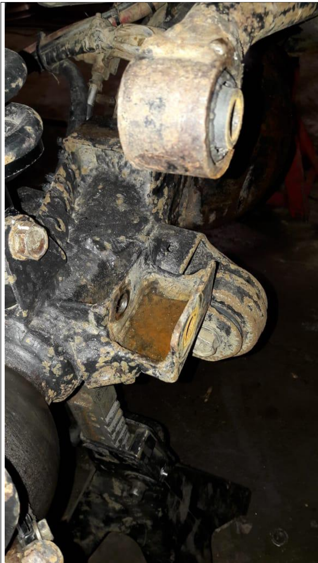
Продольные рычаги оригинал и установленные у нас (на фото справа) для сравнения
