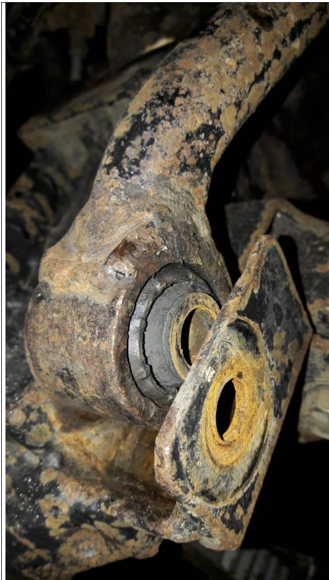
Тяги для сравнения 48740-60033 вместе с сборным и монолитным сайлентблоком
